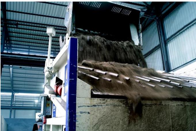
(3) Gezielte Fraktionierung von mineralischen Bauabfällen: Hochbelastetes Material wird von weniger belastetem getrennt, sodass viele Stoffe direkt vor Ort entsorgt werden können.
