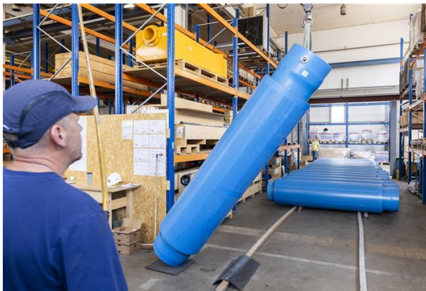
(1) Die PVC-Doppelwandfilter werden im Peiner Werk der GWE GmbH gefertigt und einbaufertig nach Dubai geliefert.
